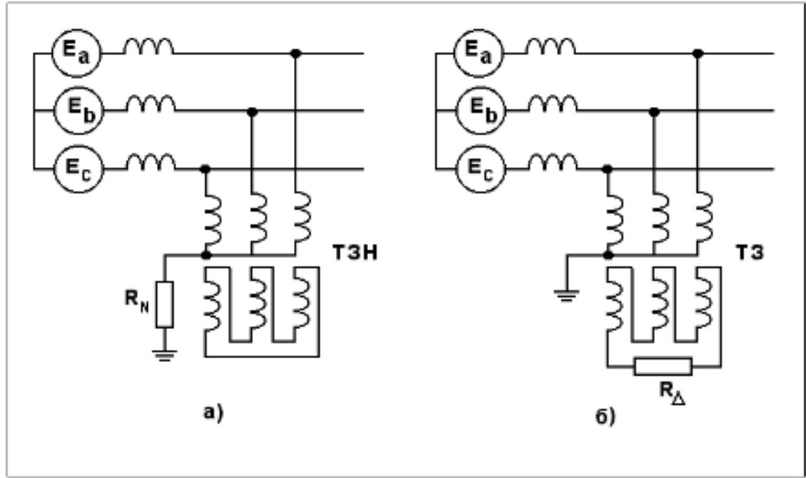
Рис. 1. Схемы подключения резистора к нейтрали сети
