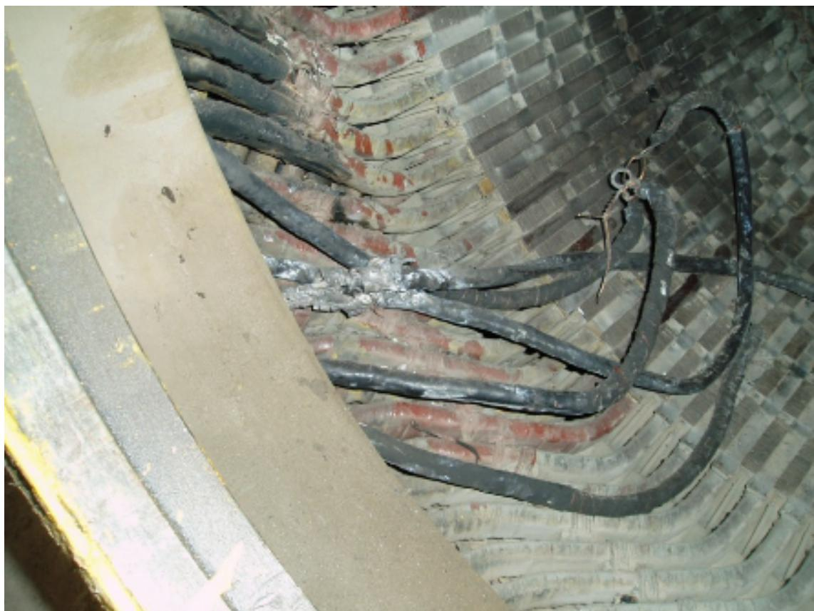
Рис.3 Статор сгоревшего электродвигателя 630 кВт в результате ОДЗ
