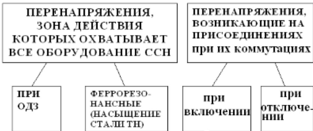
Рис.1. Классификация внутренних перенапряжений перенапряжений в сетях 6-35 кВ
