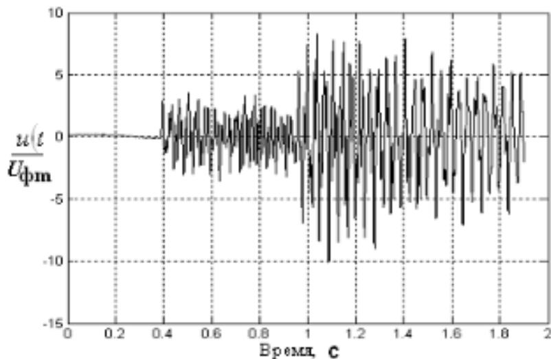
Рис.5. Напряжение на первых витках ЭД при его отключении вакуумным выключателем, сопровождающееся повторными зажиганиями дуги в ВДК
