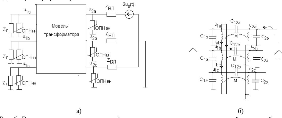
Рис.6. Расчетная схема при исследовании грозовых перенапряжений в схеме блока (а) и модель силового трансформатора (б)
