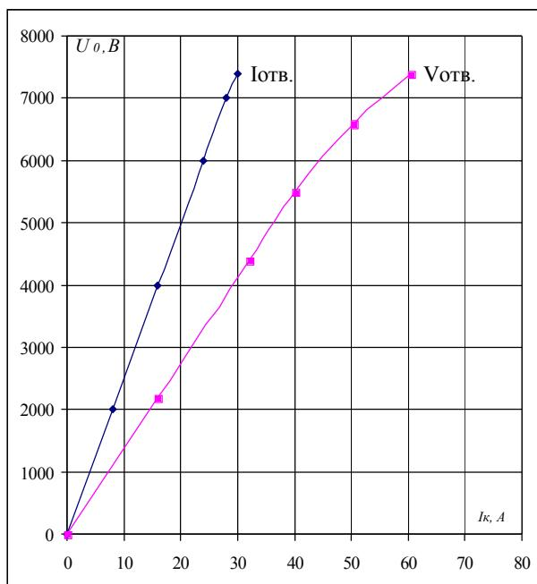
Рис.2. Вольт-амперная характеристика плунжерного дугогасящего реактора РЗДПОМ-480/10 кВ.
