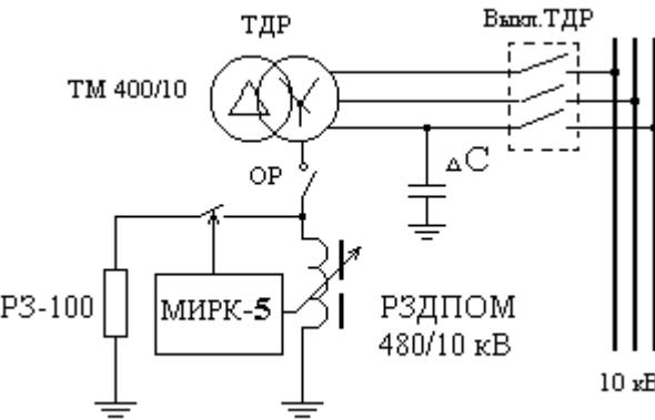
Рис.9. Схема подключения дугогасящего реактора типа РЗДПОМ и высоковольтного резистора.
