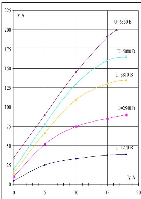
Рис.5. Зависимость тока компенсации от тока подмагничивания  $I_k=f(I_p)$  дугогасящего реактора с подмагничиванием РЗДУОМ( РЗДПОМ)-1000/10 кВ для различных напряжений на реакторе.
