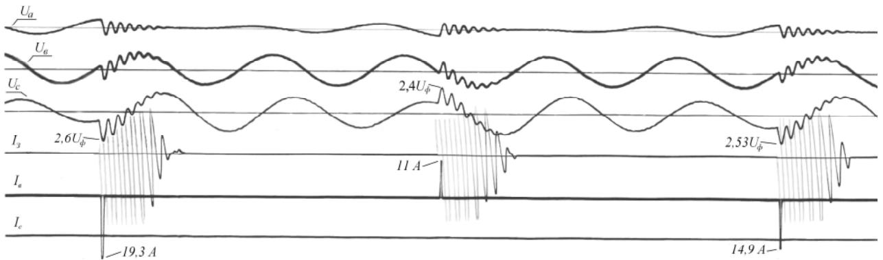
Рис.4. Дуговое замыкание на землю в сети 10 кВ ПС №94 ММК со ступенчатым дугогасящим реактором РЗДСОМ-380/10 кВ.
