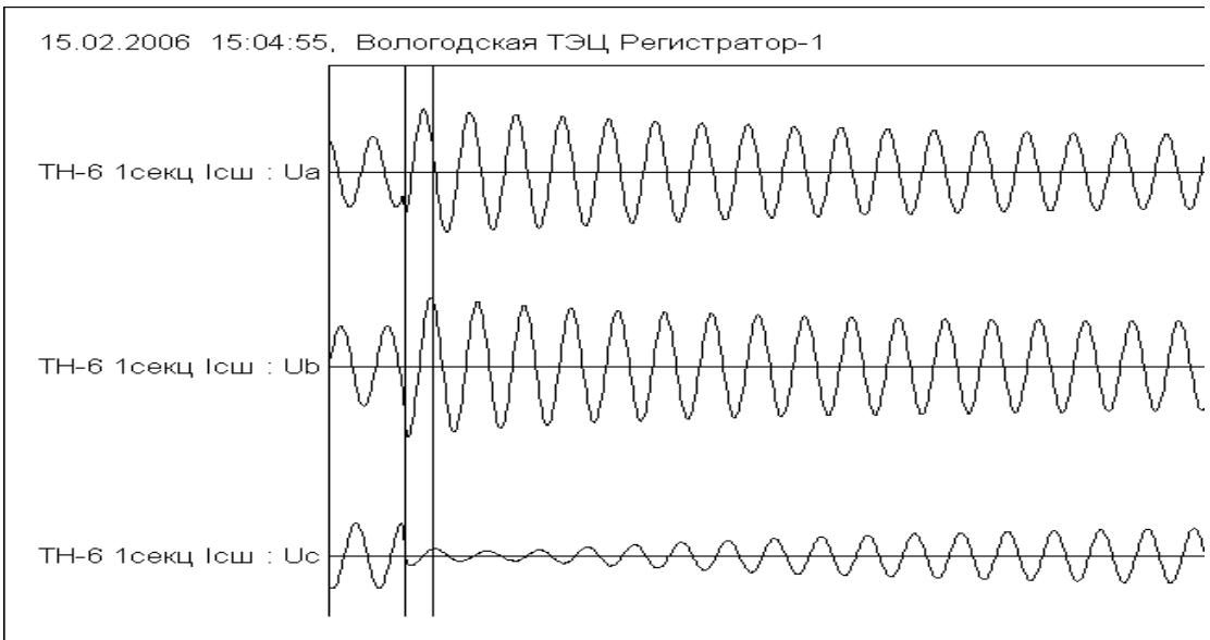
Рис.5. Дуговое замыкание на землю в сети 6 кВ Вологодской ТЭЦ с плунжерным дугогасящим реактором РЗДПОМ-300/6кВ
