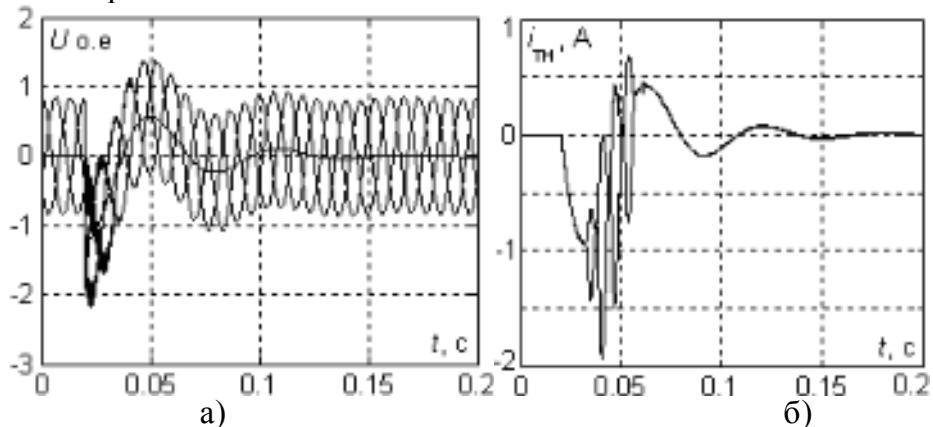
Рис.7. Компьютерные осциллограммы напряжений на фазах и на нейтрали сети (а) и токов в фазах ТН типа НАМИ (б) при одном зажигании дуги.
