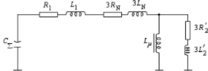
Рис.6. Эквивалентная схема сети с изолированной нейтралью и ТН типа НАМИ. для нулевой последовательности фаз
