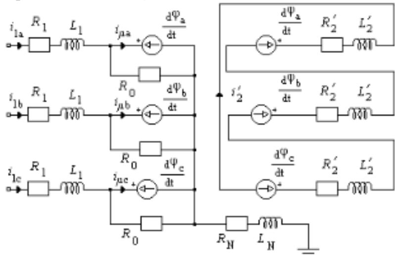
Рис.3. Электрическая схема замещения ТН.
