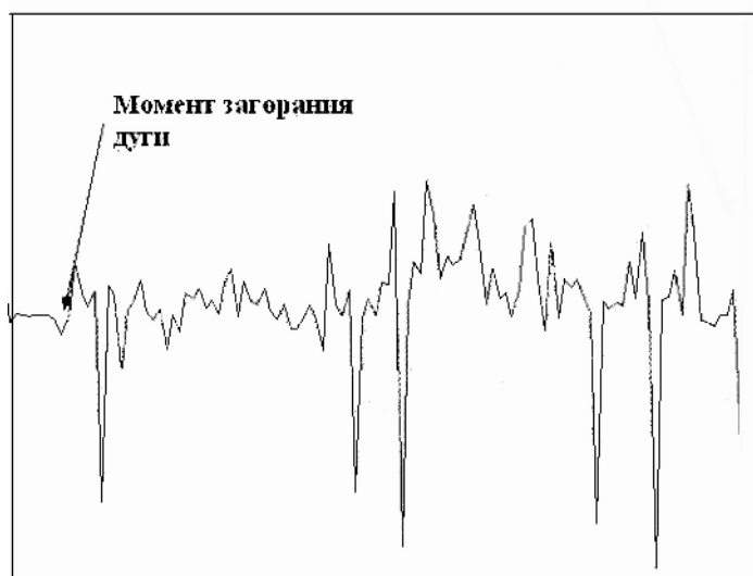
Рис.6. Зависимость фазового угла от времени в процессе замыкания на землю, сопровождающегося перемежающейся дугой
